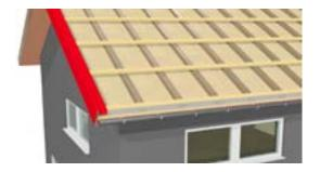
Dopo la posa della membrana impermeabilizzante viene fissata la controlistellatura sui travetti. In seguito avviene la posa della listellatura trasversale.
